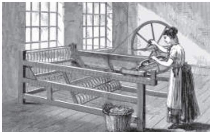
Машината за предење „Џени“ била создадена од англичанецот Џејмс Харгривс
